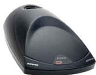
Base microfonica wireless da tavolo con interruttore. Compatibile con microfoni MX405-MX410-MX415 e con ricevitori della serie SLX. Preamplificatore integrato. Modalità di funzionamento programmabili; Schermatura RF. Filtro roll-off. Sincronizzazione tramite IR con ricevitore e selezione automatica o manuale del canale. Alimentazione: 2 Batterie tipo AA; Peso: 312 g. Dimensioni altezza 43mm larghezza 87mm profondità 148mm; Colore: Nero;
